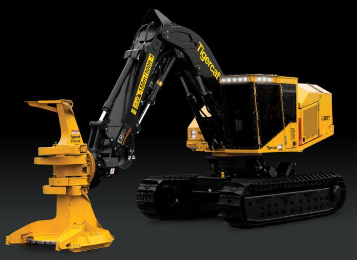
CLOSED LOOP DRIVE ALONG WITH SLOPED TAIL FOR INCREASED LEVELING CAPABILITY.
