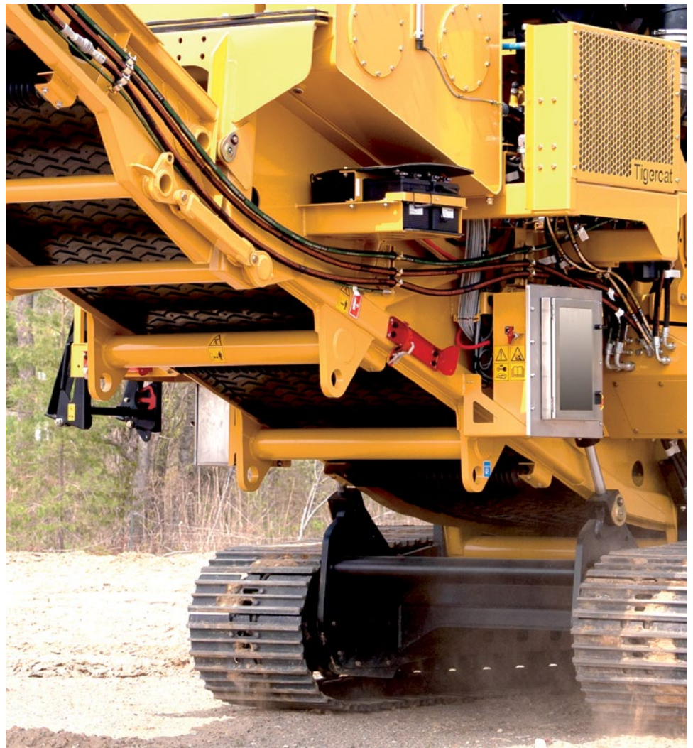
Caja de herramientas que sube y baja hidráulicamente.
